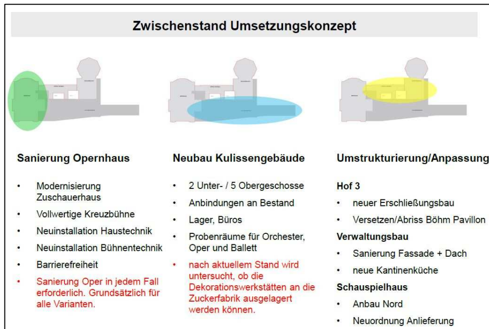
Abbildung 7: Übersicht Sanierungskonzept Variante A
